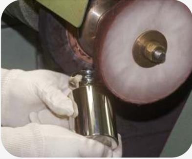
Preuve d'un savoir-faire industriel : tous nos poids sont polis à l'aide d'équipements automatiques et finis manuellement. Cette technique permet d'obtenir une surface polie miroir qui optimise l'utilisation, la qualité et la précision des masses. Autre avantage : cette action permet d'obtenir des surfaces brillantes anti-adhérentes.
