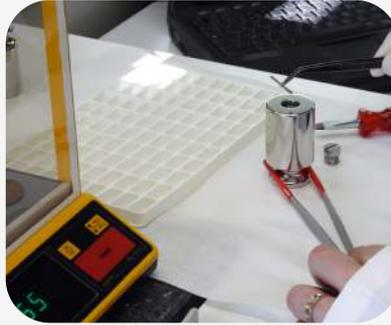
Zwiebel maîtrise les techniques d'ajustage. Leur but : donner au poids toute sa précision. Deux procédés sont mis en œuvre : l'ajout de matière (fils inox) lorsque le poids possède une cavité d'ajustage ou l'enlèvement de matière (abrasion) en cas de poids monobloc. Un travail de haute précision, notamment quand il s'agit de poids inférieurs au gramme.
